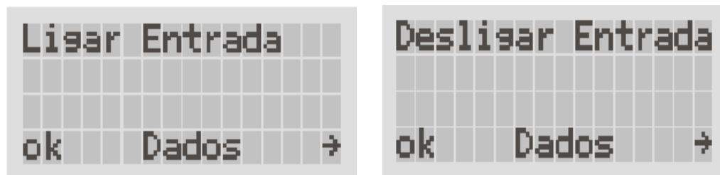
Figura 4.17 - Tela no display da UPS para desativação do inversor.
