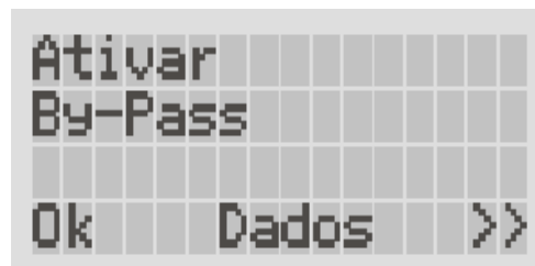
Figura 4.18 -Tela de ativação do modo bypass.
