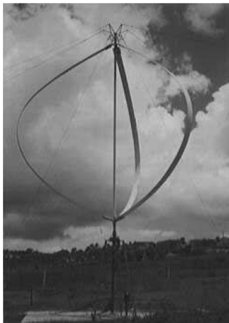
Figura 2.1 – Turbina tipo Darrius de três pás.
