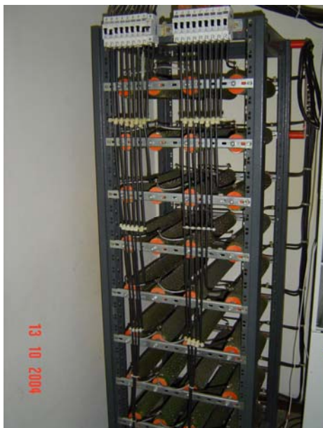
Fig. 1.2 – Banco de resistores utilizado no teste de burn-in .
