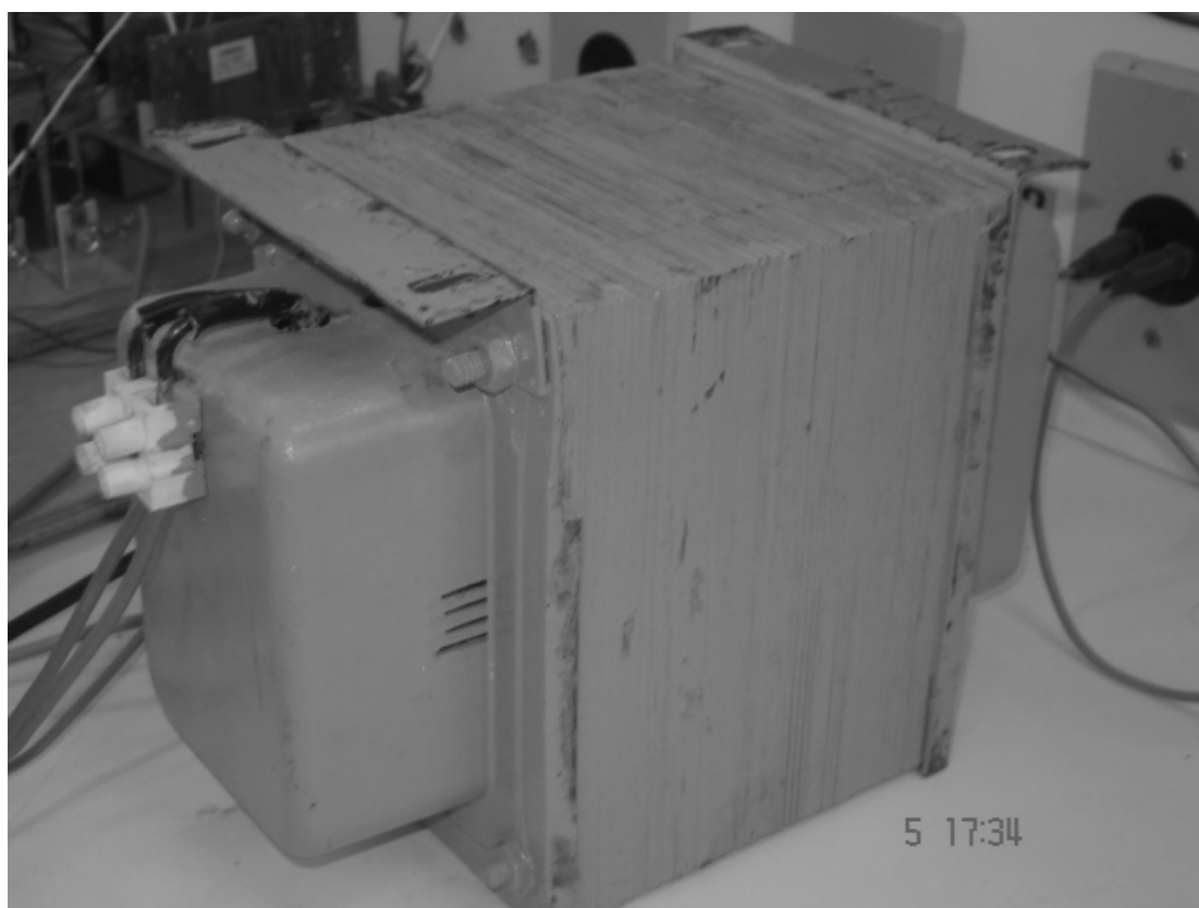
Fig. 6.18– Transformador 1000VA 60/220V
