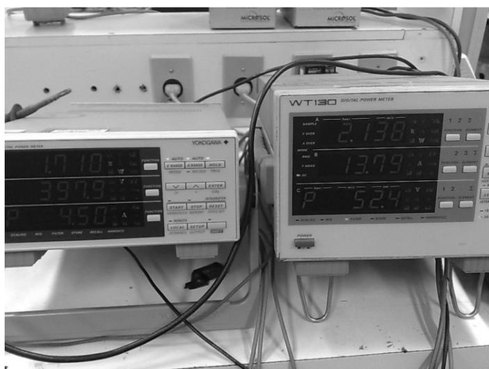
Figura 4.13 – Watímetros Yokogawa WT200 e WT130.
